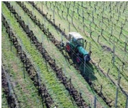
PSR ISO & PSR ADVANCED von Reichardt unterscheiden sich von anderen automatischen Lenksystemen darin, dass sie in einzigartiger Weise Satellitensignale und Sensorik, wie Ultraschall oder Reihentaster, zur Lenkung des Fahrzeuges oder Anbaugerätes einsetzen können.
